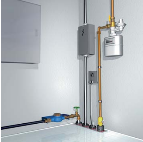
Hausanschlussraum (schematische Darstellung. Für die Ausführungen gelten die jeweiligen technischen Anschlussbedingungen) (Quelle: Fachverband Hauseinführungen für Rohre und Kabel e.V.)
